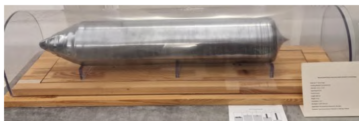
Fot. 2. Monokryształ krzemu otrzymany metodą Czochralskiego, znajdujący się w Gmachu Głównym Politechniki Warszawskiej
