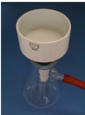
Rys. 4. Współczesny zestaw Büchnera do sączenia próżniowego [12]
