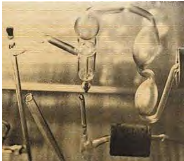
Rys. 3. Aparatura szklana do mikroanalizy zaprojektowana przez Fritza Pregla [8]
