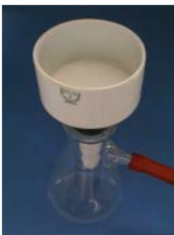
Rys. 4. Współczesny zestaw Büchnera do sączenia próżniowego [12]
