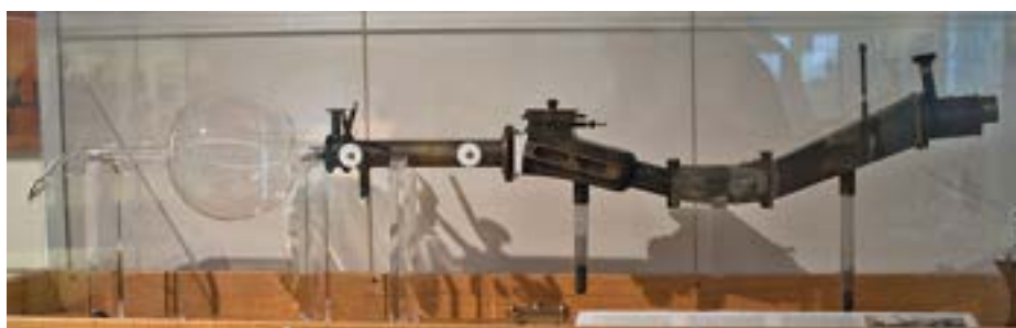
Rys. 4. Replika trzeciego spektrografu mas Francis W. Astona [Źródło: https://en.wikipedia.org/wiki/Francis_William_Aston ]
